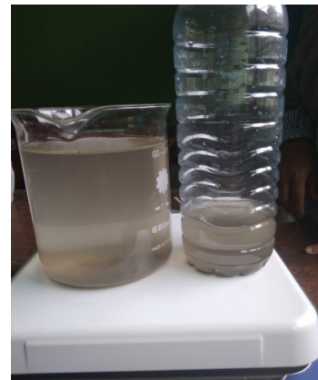
Gambar 8. Proses Koagulasi dan Flokulasi kitosan sebagai penjernih air
