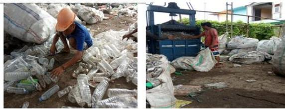
Gambar 10. (a) Pemisah; (b) Pengepresan
