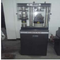
Gambar. 3.3. Alat uji tekan digital batako ringan
