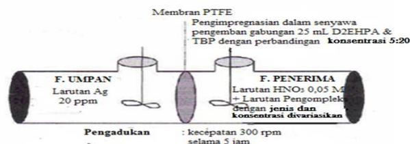
Gambar 1. Skema Kerja Alat SLM
