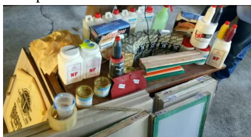
Gambar 4. Peralatan dan Bahan Screen Printing Proses Pembuatan Film/Klise
