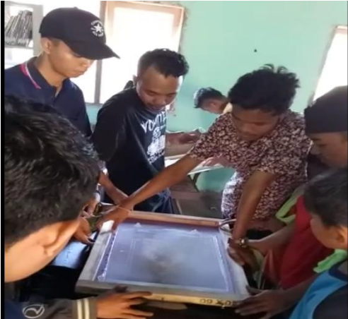
Gambar 8. Pemasangan Kaos pada Meja screen Printing
